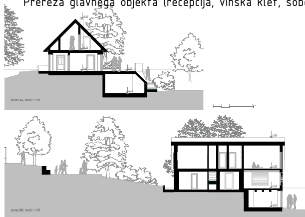
Prereza glavnega objekta (repcija, vinska klet, sobe)
